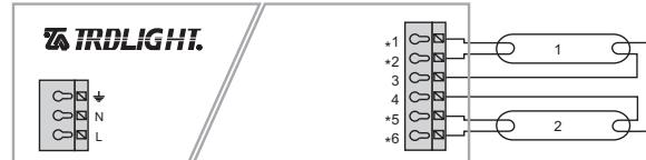
Aşağıdaki modele sahip TRDLIGHT elektronik balastlarının lamba bağlantı Şeması yukarıdaki gibi olmalıdır. Kablo uzunlukları tabloda verilmiştir.
