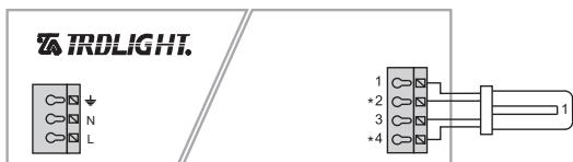
Aşağıdaki modele sahip TRDLIGHT elektronik balastlarının lamba bağlantı Şeması yukarıdaki gibi olmalıdır. Kablo uzunlukları tabloda verilmiştir.
