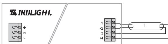
Aşağıdaki modele sahip TRDLIGHT elektronik balastlarının lamba bağlantı Şeması yukarıdaki gibi olmalıdır. Kablo uzunlukları tabloda verilmiştir.
